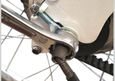
À l'aide la clé de 18, resserrez énergiquement les deux écrous et remplacez les deux cache-écrou de protection.
