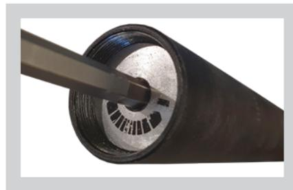
Par défaut, l'amortisseur de selle est réglé en position moyenne (ni trop dure ni trop souple). Pour ajuster la souplesse, c'est très simple : retirez la selle avec la tige de selle et à l'aide d'une clé Allen de 6 mm :
