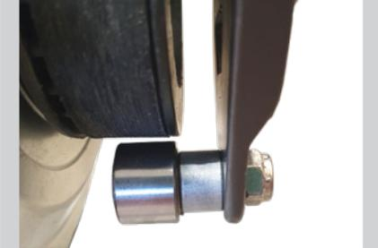
Vérifiez que le galet de la contre-poulie fixée sur la patte droite du cadre soit à une distance maximale de 0,5 mm, sans être en appui sur la courroie
