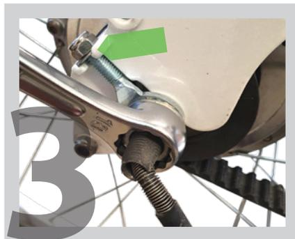
La calle placée entre les plaquettes de freins évite qu'elles ne se rapprochent (si une personne actionne les leviers de freins lorsque la roue est démontée).
